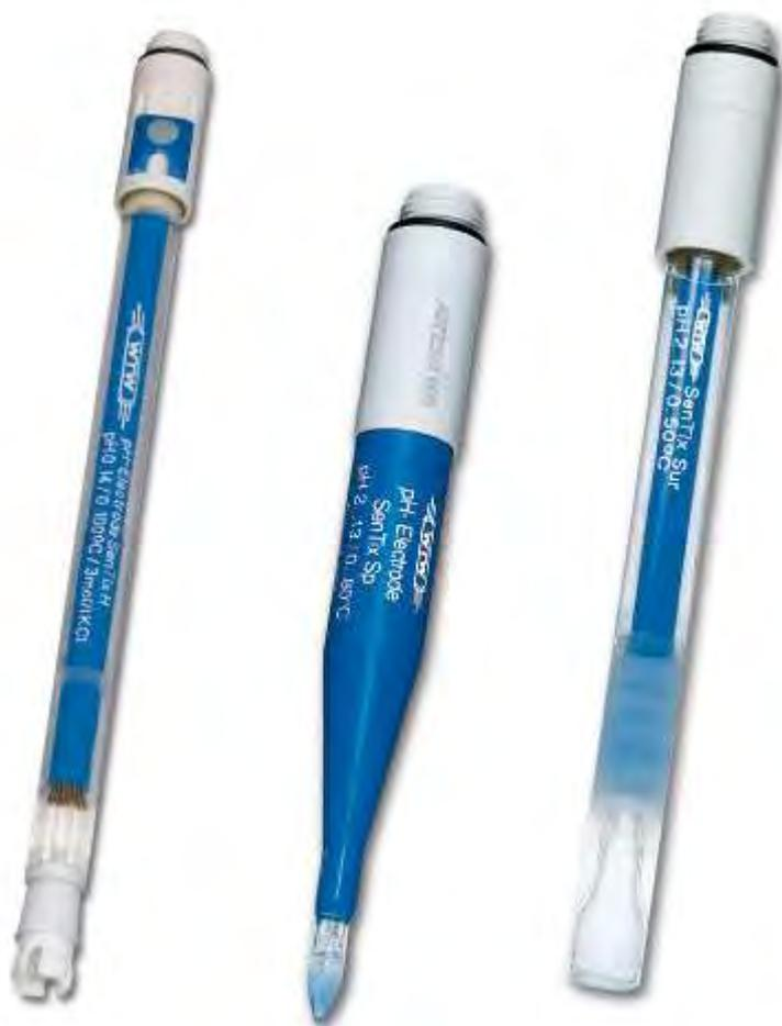
BlueLine — это линейка компактных электродов от SI Analytics для обычных лабораторных задач. Качество и скорость измерений обеспечивается точностью изготовления и применением исключительно высококачественных материалов, например, А-мембранного типа стекла с низким сопротивлением или уникальной платиновой диафрагмы.
